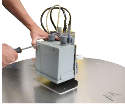
Foto 14: Extracción del panel frontal
