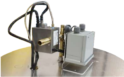
Foto 25: Conexión del nipple de 3/4 in x 3 in a la válvula de platino
