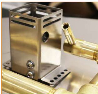
Foto 4b: Posicionamiento de apertura circular de la jaula de viento
