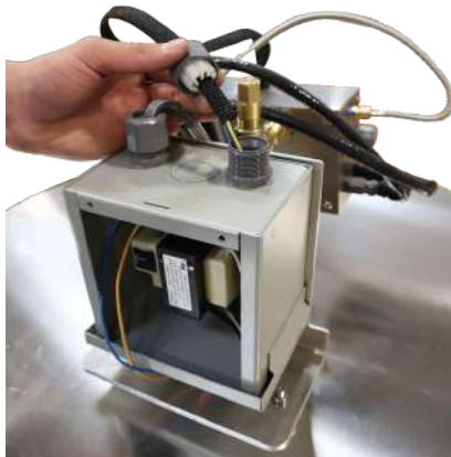
Foto 16a: Introducción de los cables de las válvulas en la caja del transformador
